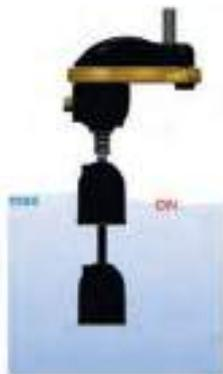
Le niveau maximum actionne la pompe et le réservoir se vide
